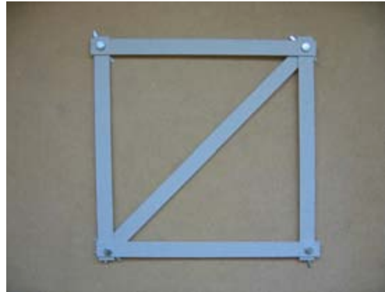
Prinzip der Versteifung von Rechtecken mit einer Diagonalen (Kartonstreifen und Rundkopfklemmern).
