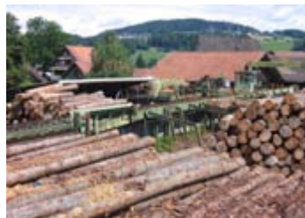
Holzverarbeitung: Die 2. Phase im Holzkreislauf. Das angelieferte Rundholz wird als erstes entrindet und dann gesägt.
