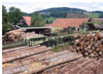
Lavorazione del legno: la 2ª fase del ciclo del legno. I tronchi consegnati vengono prima scortecciati e poi segati.
