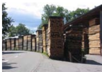
Cataste di tavole lungo la strada: il legno espoto all'aria secca lentamente e in modo naturale.
